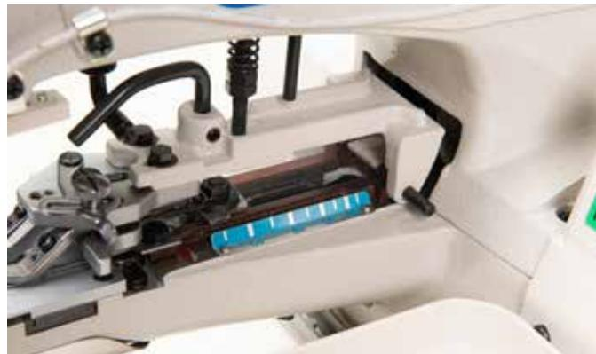
Při šití čtyřděrových knoflíků se přední/zadní rozteč otvorů nastavuje pomocí mechanismu na rameni stroje.
