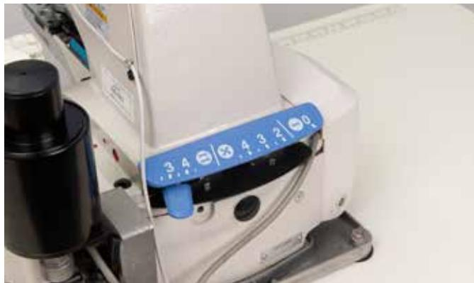
Nastavení druhu knoflíků (dvouděrový nebo čtyřděrový) a způsob jejich příští (paralelní nebo křížový) se nastavuje pomocí páky s přehlednou stupnicí.
